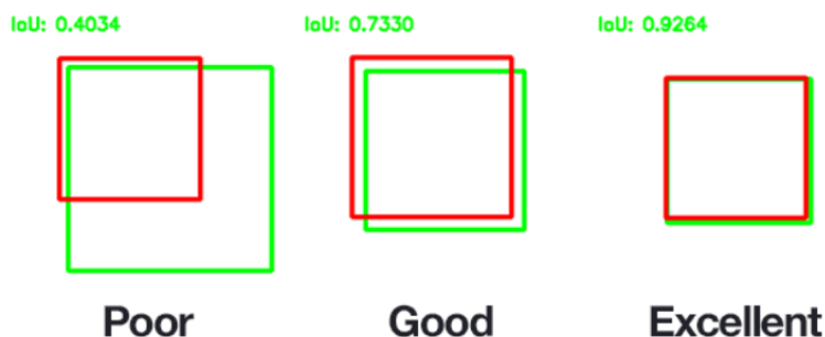
FIG. II.13 : Exemple intersection sur Union (IoU)
