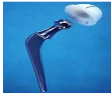
Prothèse totale de la hanche en alliage CoCr (état après 38 ans d'implantation)
