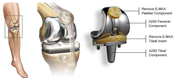
La Prothèse tibiale est en générale en Titane Ti6Al4V
