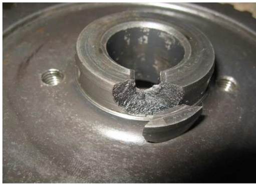
Figure I.3. Détachement d'une partie d'une roue dentée. [1]
