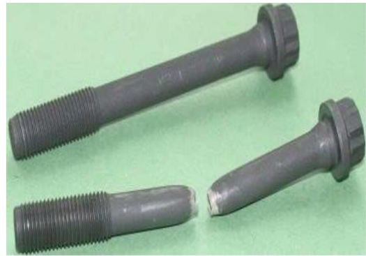
Figure I.4. Rupture d'un tirant. [1]
