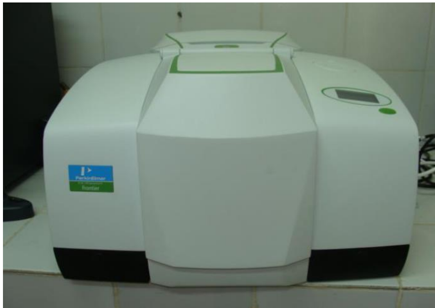
Figure 2.8: Spectromètre FT IR (PerkinElmer)
