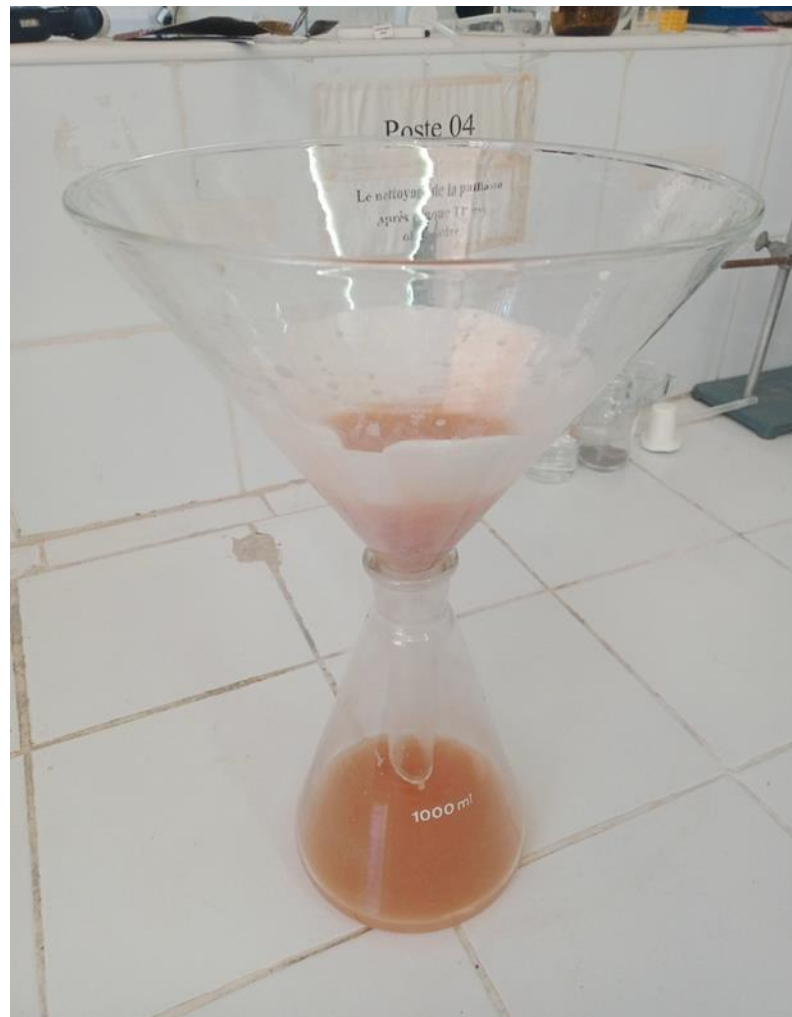
Figure 3.6 : filtration après la fermentation.
