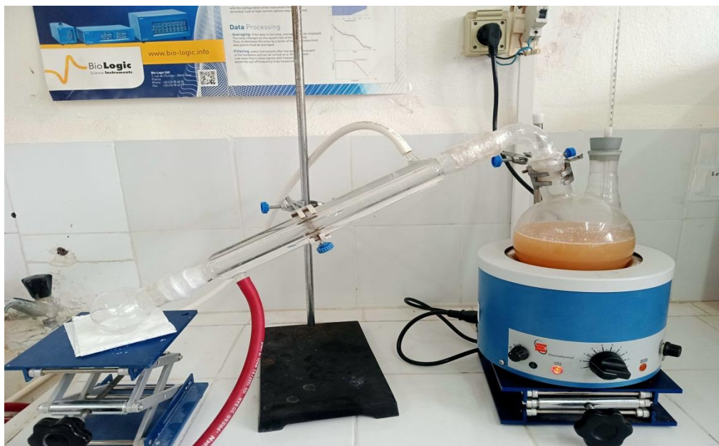
Figure 3.8 : Dispositifs utilisés pour la distillation.
