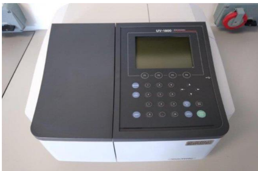
Figure 2.7: Spectrophotomètre (Shimadzu UV 1800).
