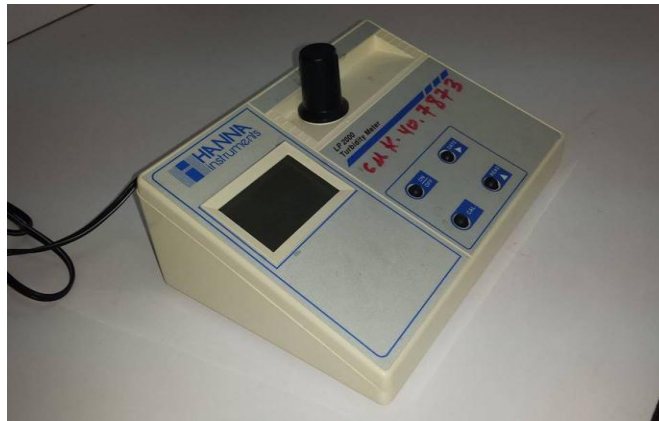
Figure III.6 : Turbidimètre utilisé pour les mesures de turbidité des surnageants.
