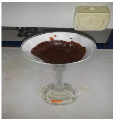
Figure III.3 : La boue récupérée après décantation.
