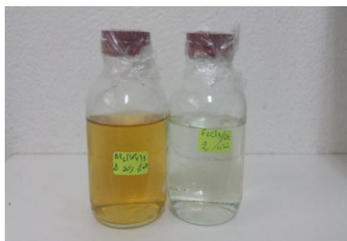
Figure III.4 : Les surnageants récupérés après décantation.
