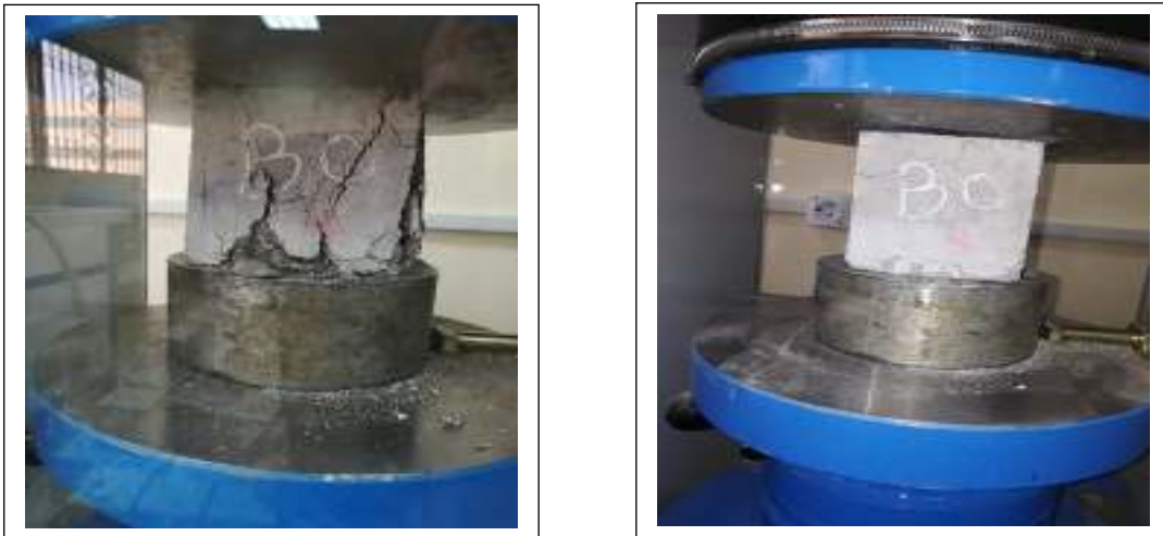
Figure –N°33-: Fissuration brutale des éprouvettes en béton ordinaire et sa ruine à l'état de rupture
