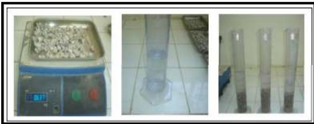
Figure –N° 22 -: Mesure de la masse volumique absolue des graviers.
