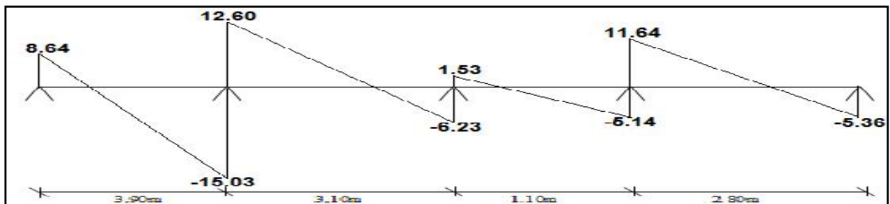
Fig III-4-13 :Diagramme des efforts tranchants à ELU type ( 2 )plancher Etage
