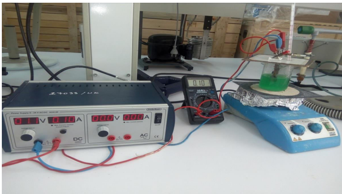
Fig. (III.6) : Schéma de montage d'électrodéposition.
