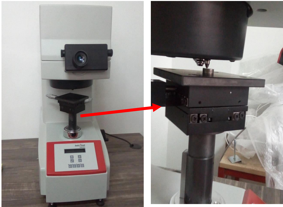
Figure .II.6 : appareil utilisé pour la mesure de la micro-dureté de type ZWICKE.
