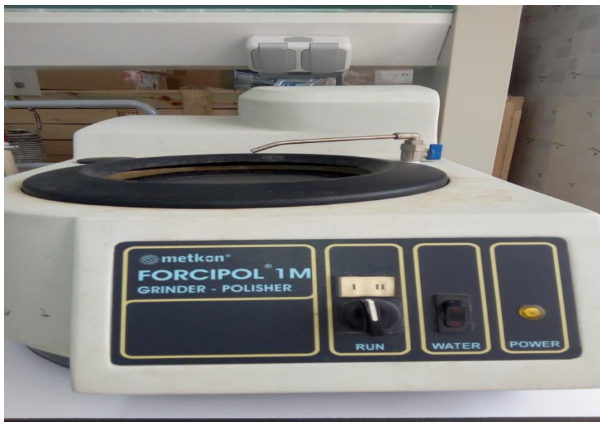
Fig. (III.2) : Schéma de polisseuse utilisé dans le polissage mécanique.
