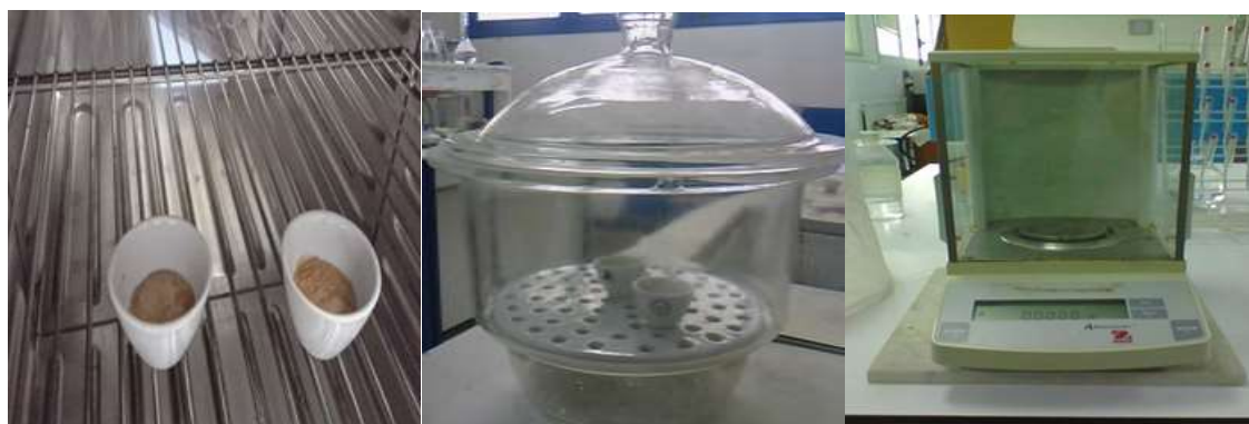
Photographie 14 : Les étapes de mesure matière séché.
