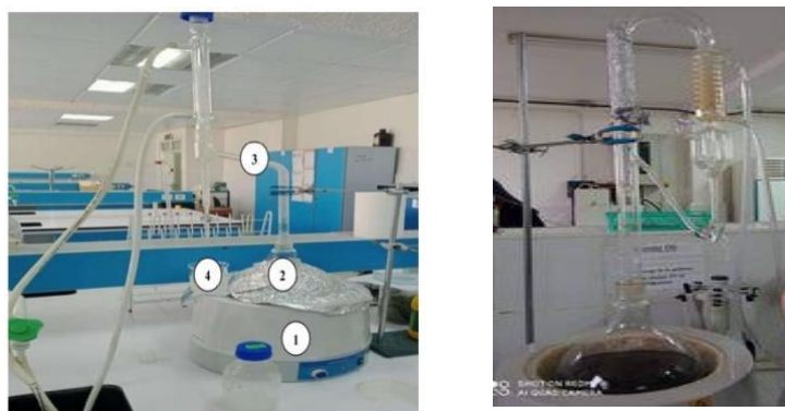
Figure 09 : dispositif d'extraction Clevenger
