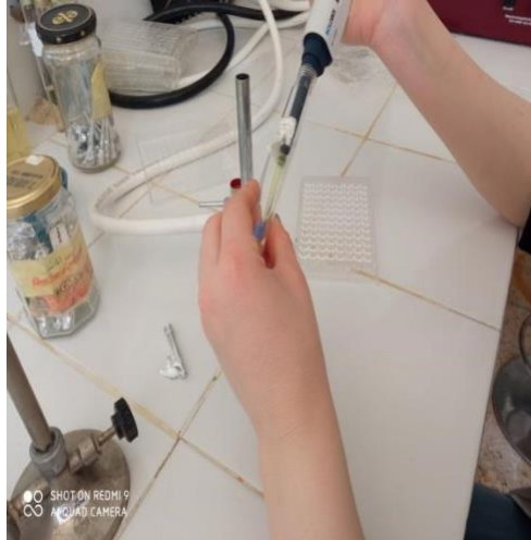
Figure 12 : dépôt des suspensions bactériennes dans les microplaques
