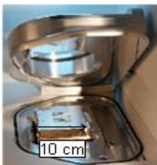
Fig. 22. Photographie de deux échantillons fixés sur un support de 10 cm et placés dans un sas d'introduction d'un système K-alpha de ThermoFisher
