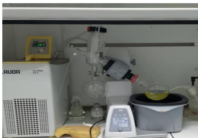
Figure5: Appareil Rotavapor pour l'évaporation du solvant
