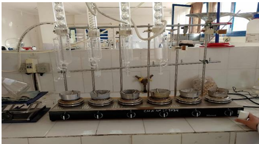
Figure 7. Appareil d'extraction Soxhlet utilisé dans cette étude.
