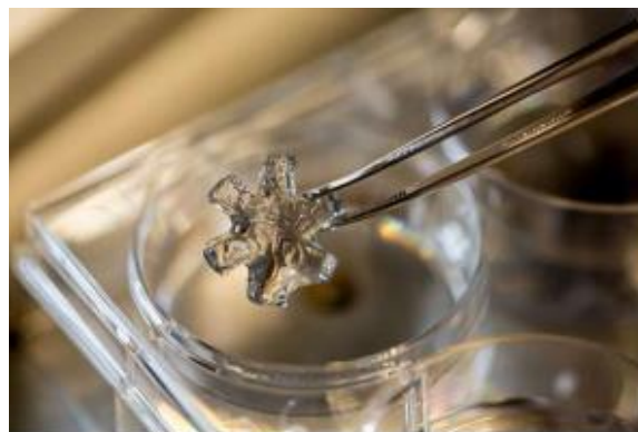
Figure I-26 des CNT se trouvent dans l'hydrogel de cet échantillon, et qui peuvent détecter la présence de molécules signalant le début d'une maladie. Généralement, une partie de cet hydrogel est placée sous la peau d'un patient et servir pendant plus d'un an à surveiller l'apparition de ces molécules. l'apparition de ces molécules.
