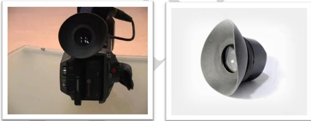
صورة رقم (08): توضيح العازل المطاطي لمحدد الرؤية صورة رقم (09): توضيح محدد الرؤية
