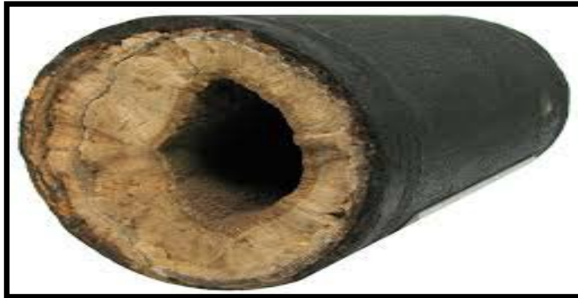
Figure III.5 : Dépôt de Sulfate de calcium ( \text{CaSO}_4 ) dans une conduite
