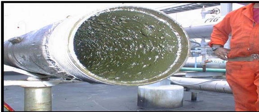
Figure III.2 : Dépôts des paraffines dans une conduite
