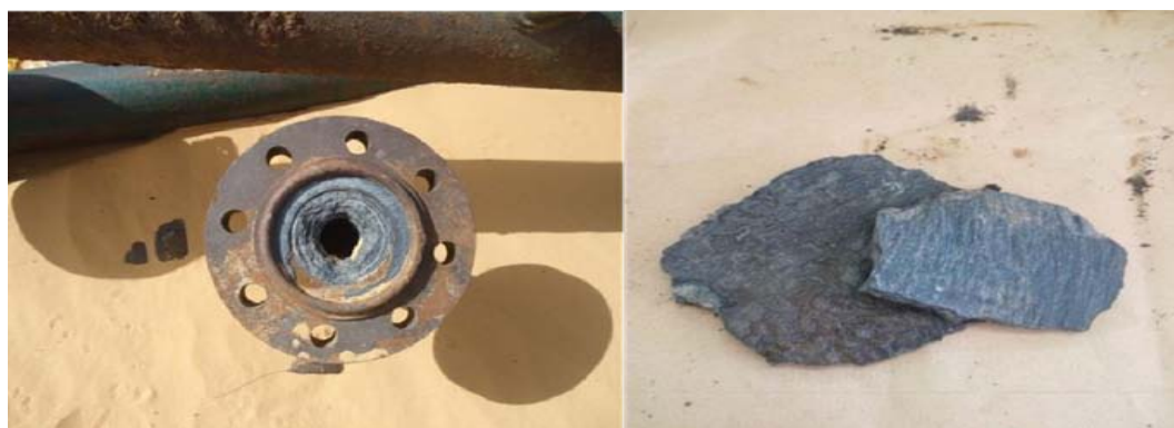
Figure IV.1 : Dépôt de Sulfate de baryum ( \text{BaSO}_4 )
