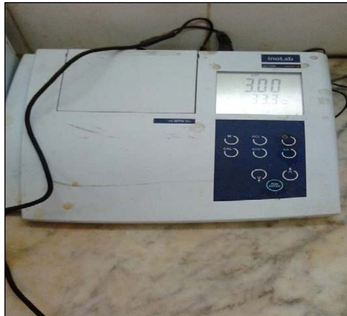
Figure V.2 : pH mètre utilisé dans l'opération d'analyse des dépôts
