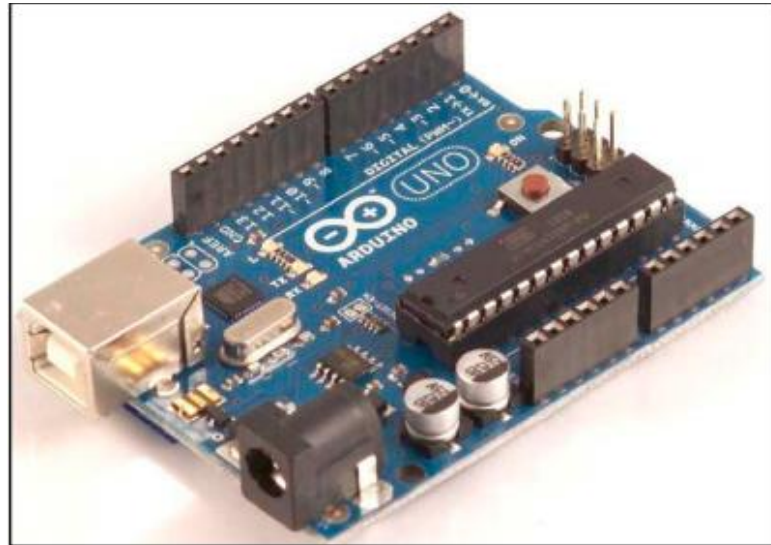
Figure(IV.1) :La carte Arduino UNO.
