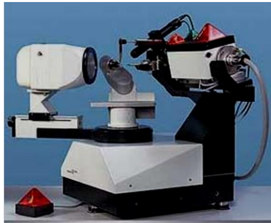
Figure7: Diffractomètre automatique à quatre cercles kappa CCD de Bruker-Nonius
