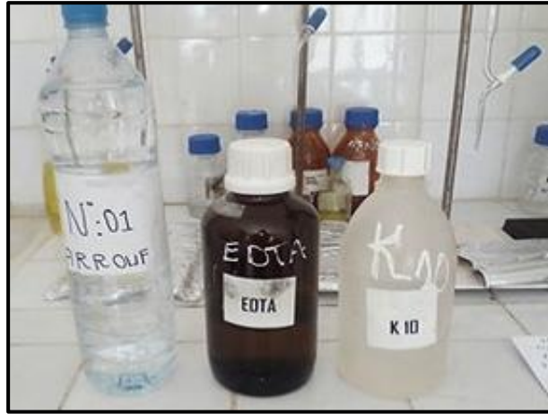
Photographie 3. Le titrage de la dureté Totale
