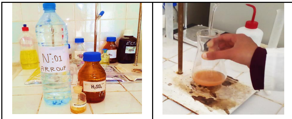
Photographie 6. Le titrage du titre alcalimétrique complet.
