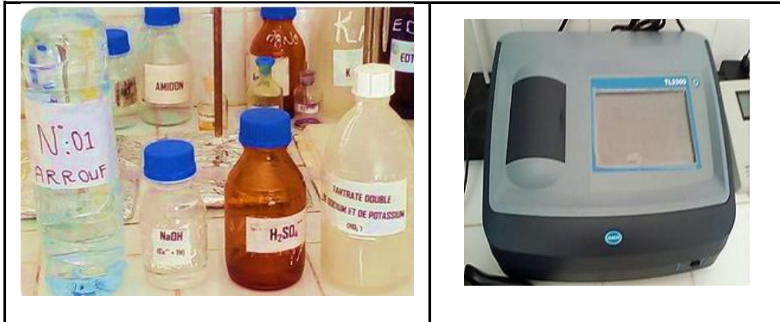
Photographie 5. Dosage des nitrates par spectrophotomètre.
