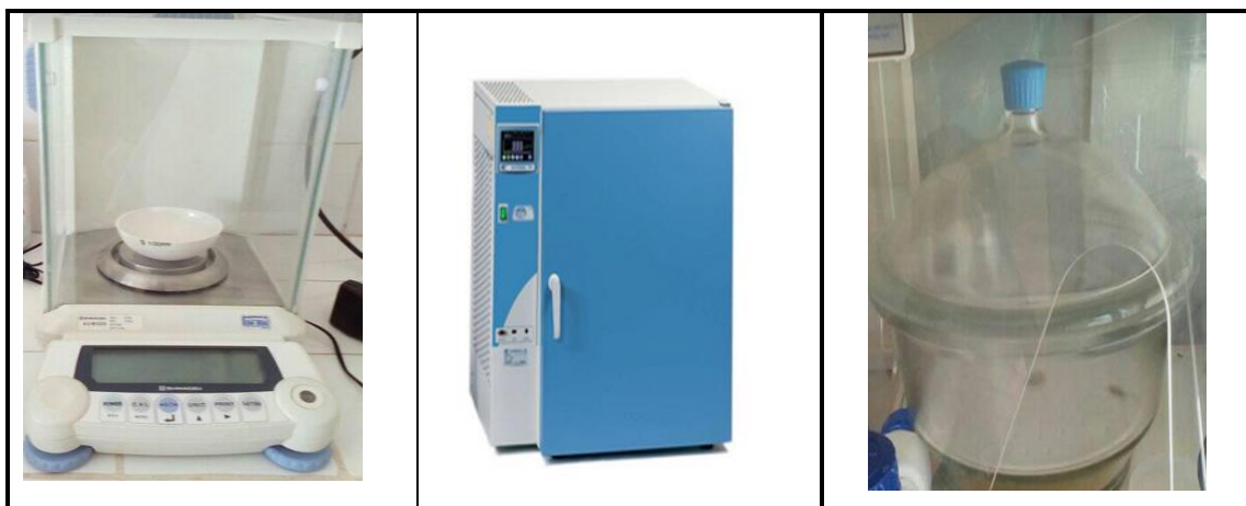
Photographie 4. Matériel utilisé pour la détermination du résidu sec.
