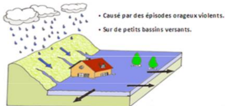
Figure 14. Inondation par ruissèlement en secteur urbain (Merabet, A. 2006).
