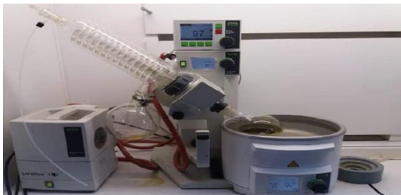
Figure 01 : Montage de l'évaporateur rotatif de laboratoire.
