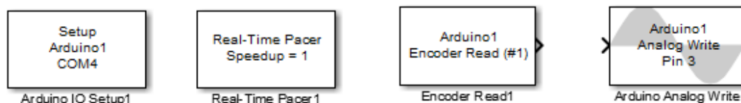
Figure III.16 : Les Blocs d'ArduinoIO nécessaires pour la commande
