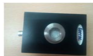
Un porte-échantillon content la pastille à analyser
