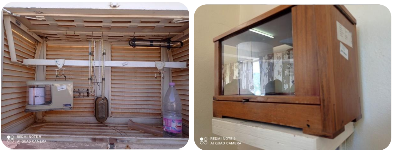
Figure 03. Abri météorologique incluant un Thermomètre à mercure, alcoolique et un Thermographe à gauche et à droite un Barographe (photos prises de la station d'El Hamma) (prises par l'auteur)
