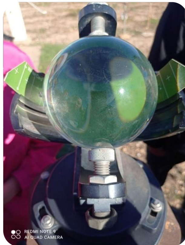
Figure 04. Héliographe (Station d'El Hamma) (Prise par l'auteur)
