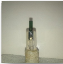
Figure 3.16. Reflet vert formé du film PANI à la surface de l'électrode de carbone vitreux.
