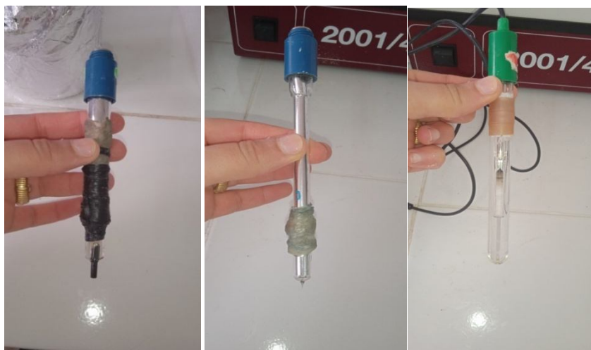
Figure 3.1. De gauche à droite, électrode de travail, contre électrode et électrode de référence.
