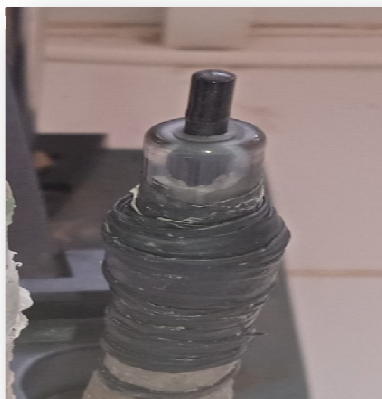
Figure 3.12. Dépôt de nanotubes de carbone et de chitosane sur la surface de l'électrode polyaniline/ nue.
