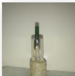
Figure 3.6. Reflet vert formé du film PANI à la surface de l'électrode de carbone vitreux.
