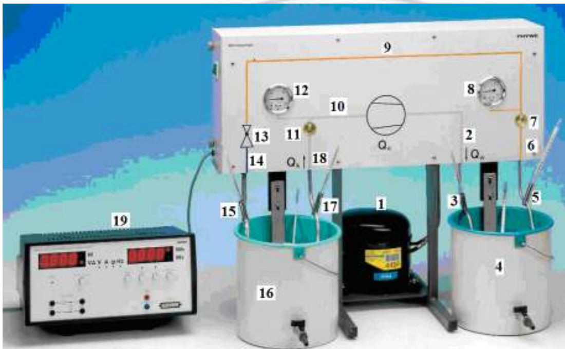
Fig. 4.2. Dispositif expérimental : Pompe à chaleur à compression (Phywe)
