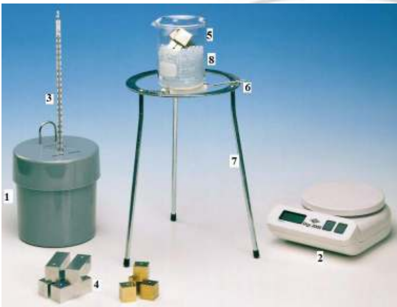
Figure 3. Dispositif expérimental : calorimétrie (Phywe)
