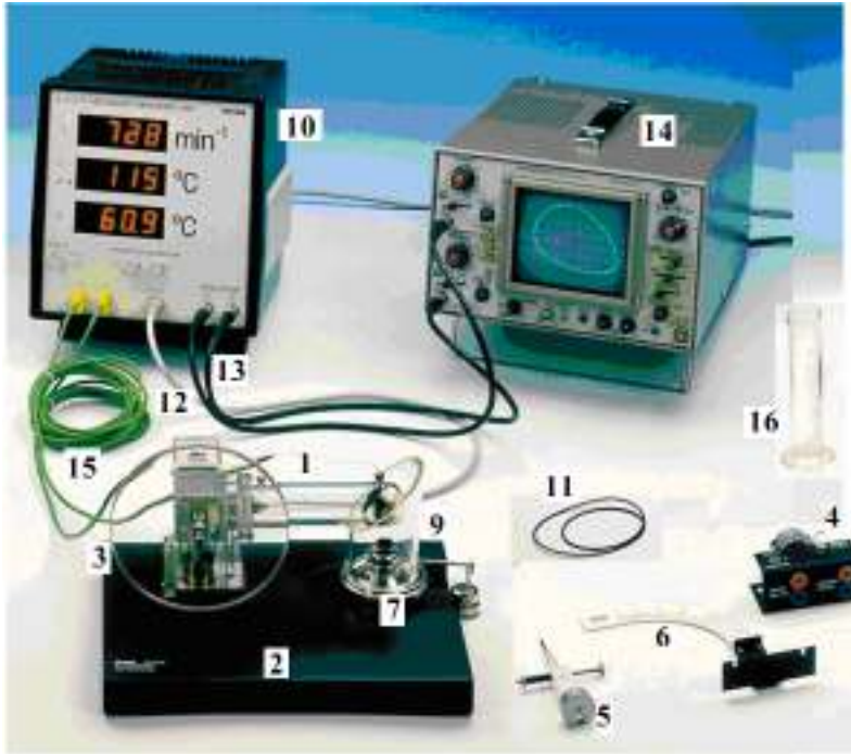
Fig. 3. Dispositif expérimental : Moteur Stirling (Phywe)
