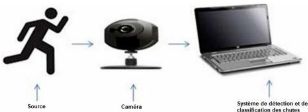
Figure I. 8. Système de détection des chutes basé sur la vision [22].
