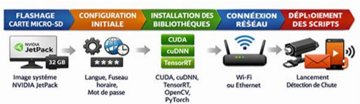
Figure IV. 4. Configuration de la carte Nvidia Jetson Nano.
