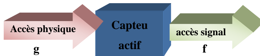
Figure I.5. principe d'un capteur actif.
