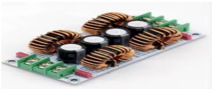
Figure 47 Filtrage de la tension de sortie
