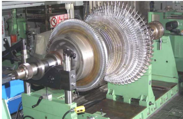
Figure 7. Equilibrage d'un rotor d'une turbine.
