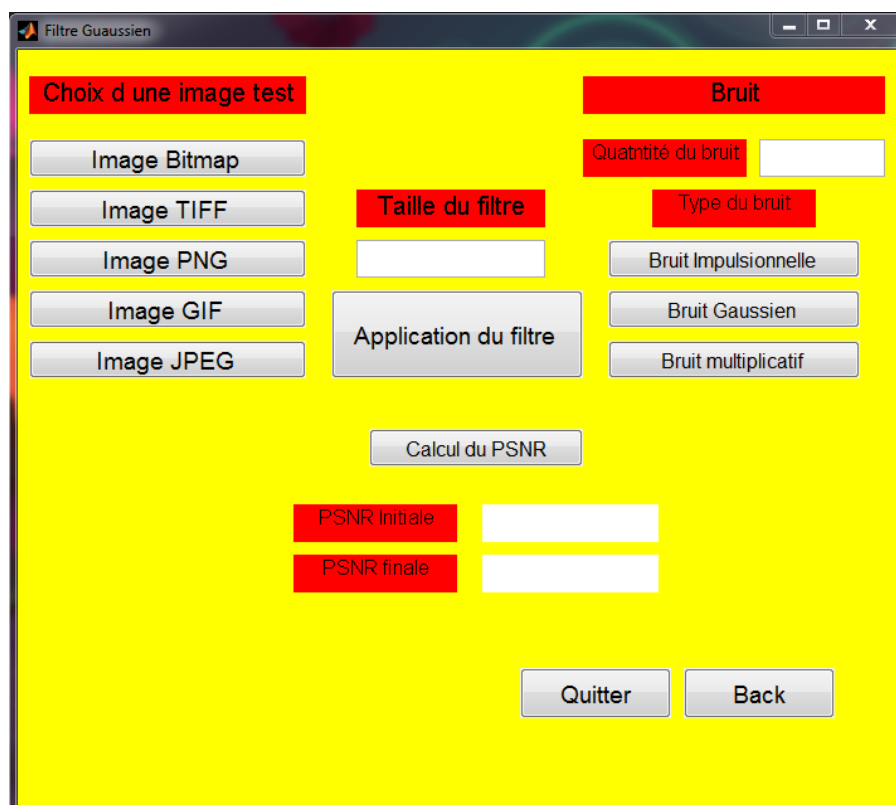
Fig. 3.3 : Contenu de la fenêtre « Filtre Gaussien »
