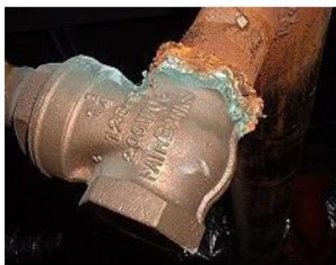
Figure I.7. Corrosion galvanique résultante d'un assemblage de deux métaux différents : robinet en cuivre et conduite en acier galvanisé [7].
