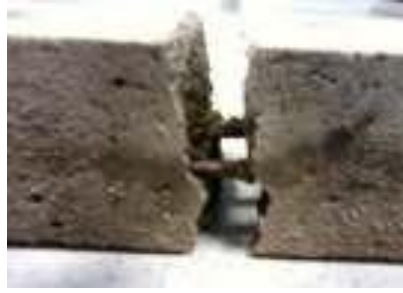
Figure 33 : Eprouvette avec tiges après rupture du mortier
