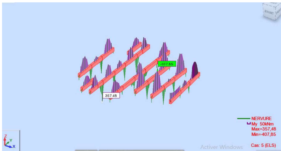
Figure.VI.11 : Diagramme des moments des nervures sens Y-Y à L'ELS
