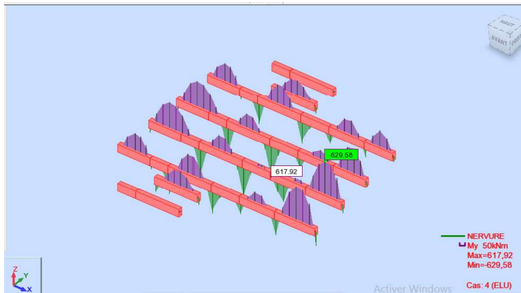
Figure.VI.8: Diagramme des moments des nervures sens X-X à L'ELU
