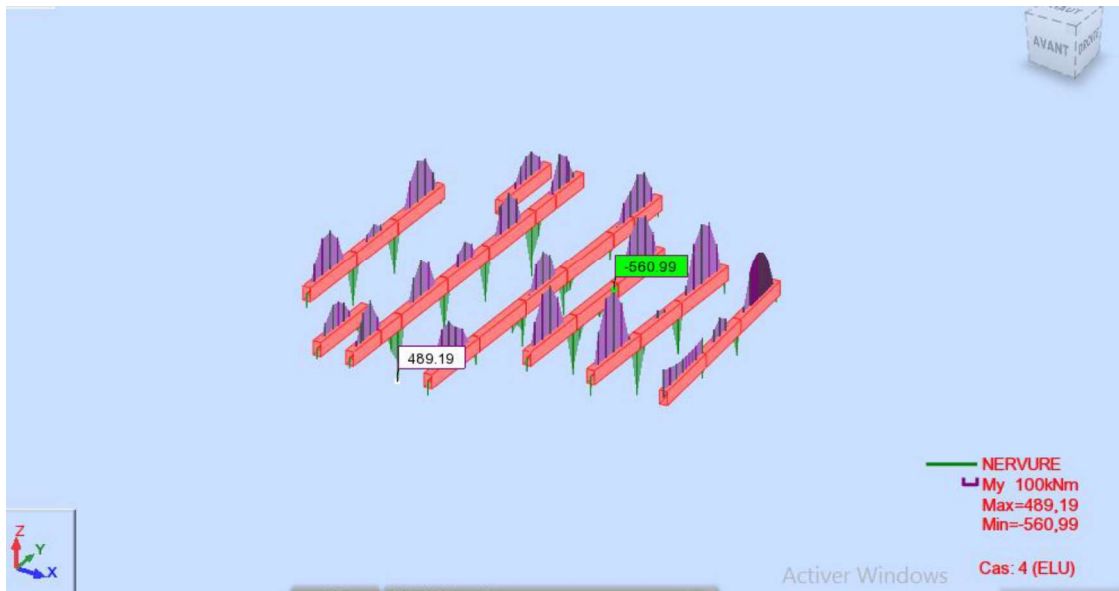
Figure.VI.10: Diagramme des moments des nervures sens Y-Y à L'ELU
