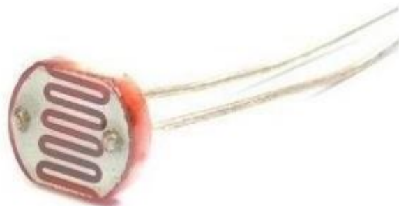
Figure II.18 : capteur analogique : photorésistance Exemple d'un (capteur analogique passif).
