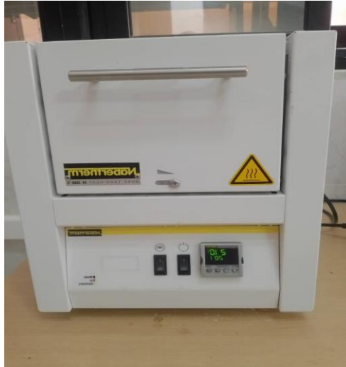
Figure II.17 : four de traitement thermique.
