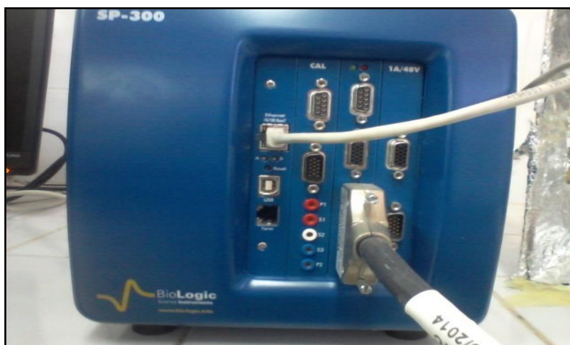
Figure III.2. Potentiostat/galvanostat utilisé pour les mesures.
