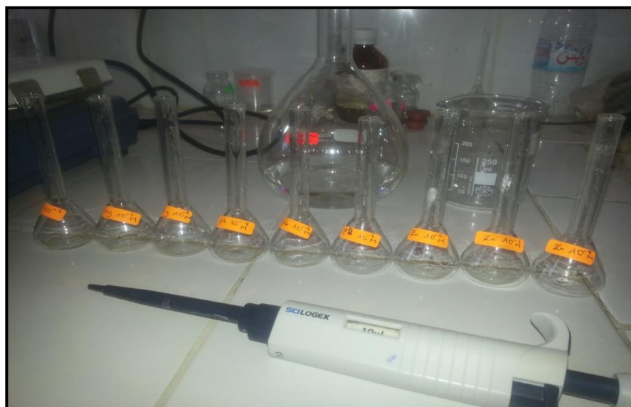
Figure III.13. Concentrations croissantes de cadmium ( 10^{-13} – 10^{-4} ) dans un PBS (pH=4.5).
