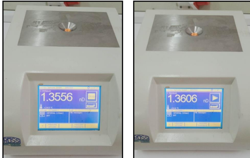
Figure V.4. Résultats des mesures de l'indice de réfraction du bioéthanol obtenu à partir des déchets de citrouille.
