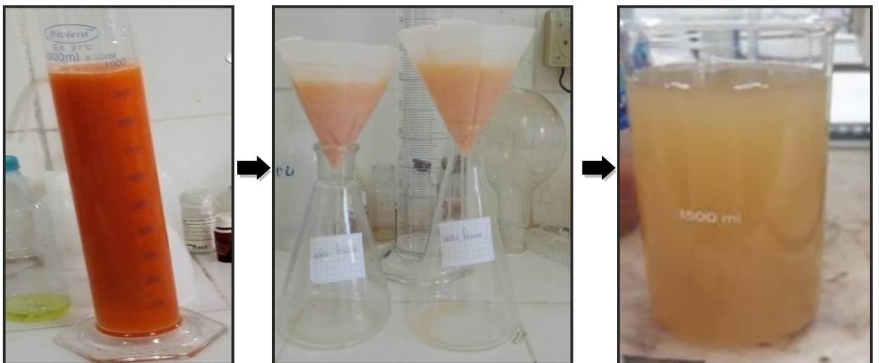
Figure IV.11. Filtration du moût de citrouille fermentée avec levure.
