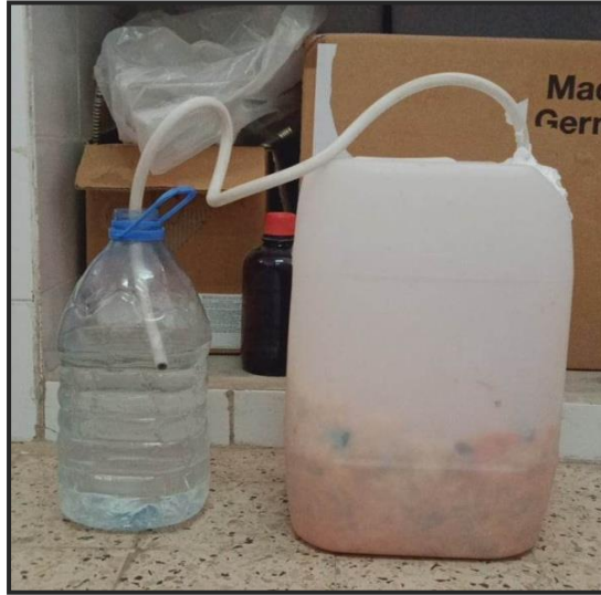
Figure IV.6. Récipient de fermentation des déchets de citrouille sans utiliser de levure.
