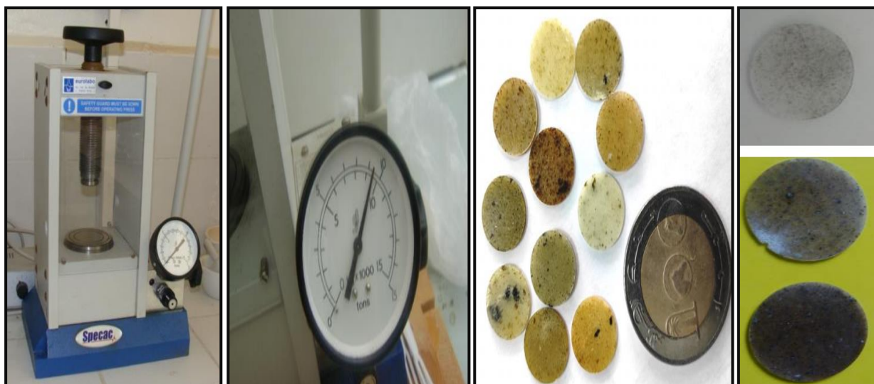
Figure IV.18. Presse Hydraulique et exemple des pastilles.
