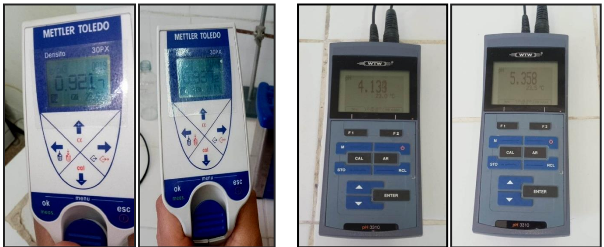
Figure V.3. Résultats des mesures de la densité et de pH de bioéthanol obtenu à partir des déchets de citrouille avec et sans levure.
