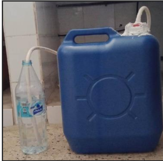
Figure IV.7. Récipient de fermentation des déchets de citrouille avec la levure.
