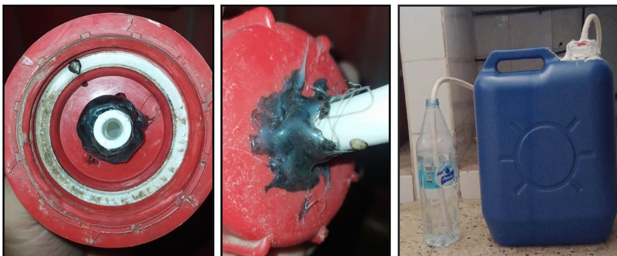
Figure IV.5. Le bouchon du jerrican attaché au tube et le récipient de fermentation.
