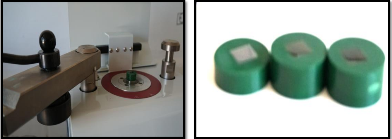
Figure III.5. Les éprouvettes C1, C2, C3 après l'enrobage.
