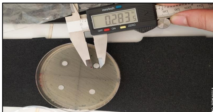
Figure 12 : Mesure des halos d'inhibition.
