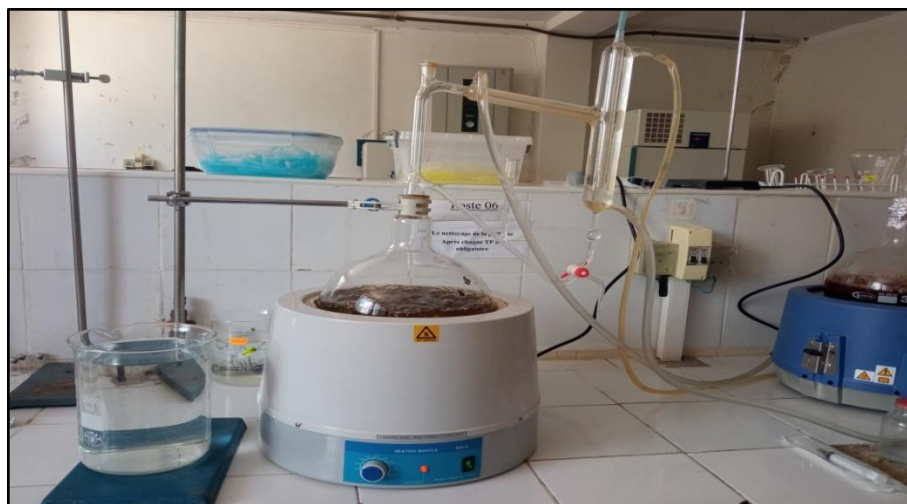
Figure 06 : Montage utilisé pour l'extraction des HEs et leurs dérivés.
