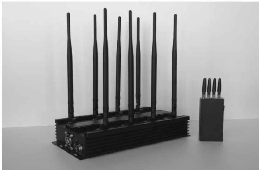
Figure II.6 exemples de brouilleurs GNSS multifréquences: brouilleur du bureau réglable (à gauche) et périphérique de lecture à quatre antennes (à droite).
