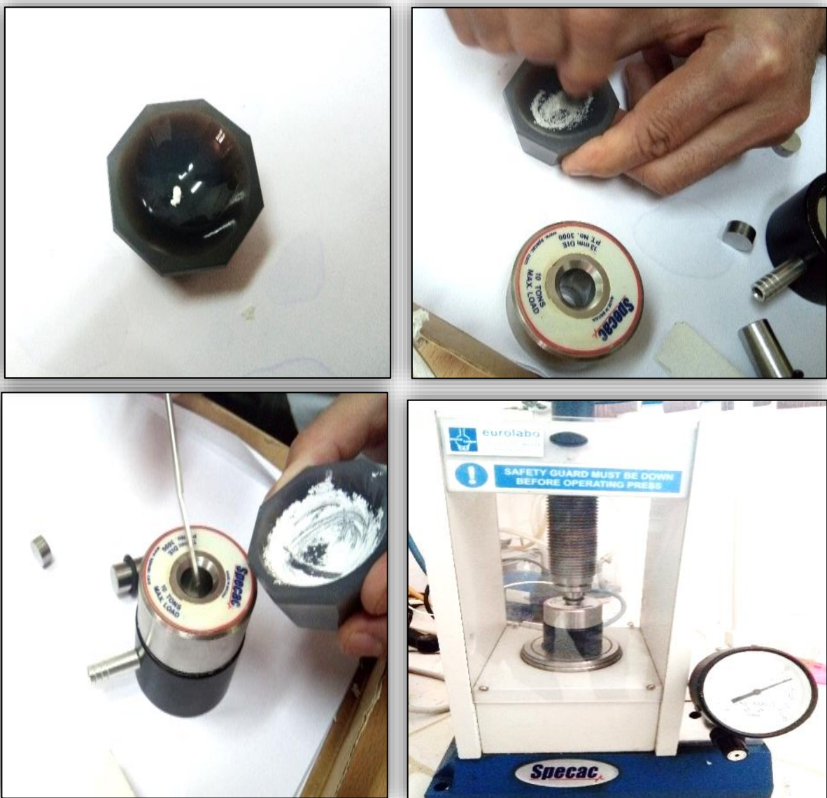
Fig (IV.7): Etapes d'obtention des pastille. [15]
