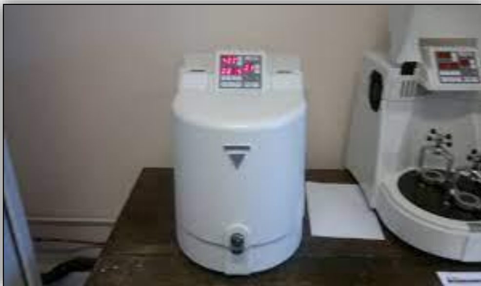
Fig (IV.32): Broyeur type planétaire [12].
