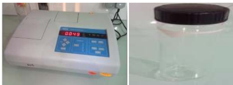
Figure 08 : Turbidimètre et la Cuve
