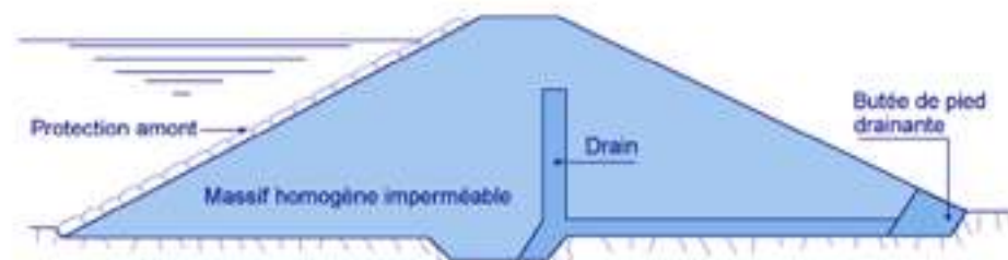
Figure 05 : Coupe d'un barrage en terre homogène. (05)
