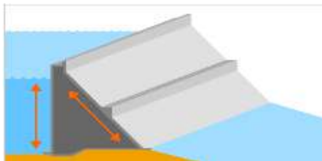
Figure 04 : Coupe d'un barrage poids. (04)
