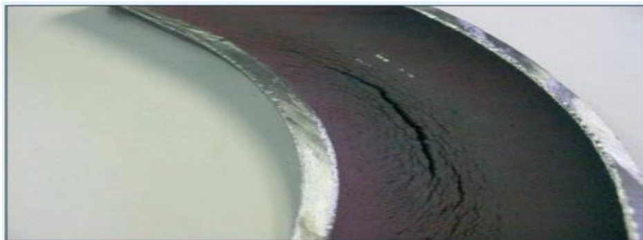
Figure I.12: Défaillance par la fatigue-corrosion d'un tube d'économiseur à basse pression. [29]
