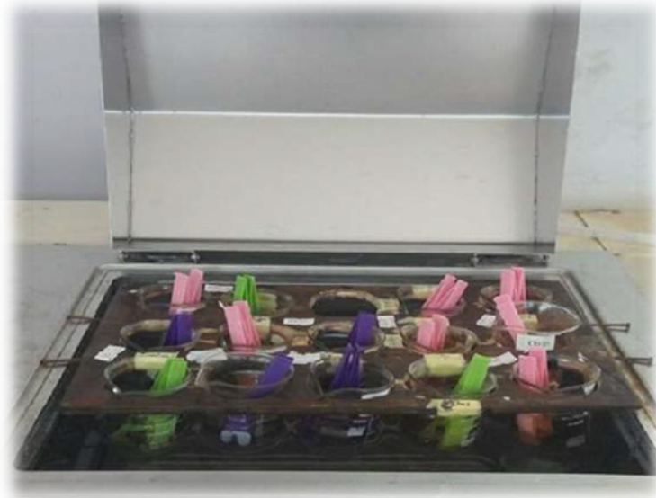
Figure III.5 : Dispositif expérimental de la méthode de la masse perdue.
