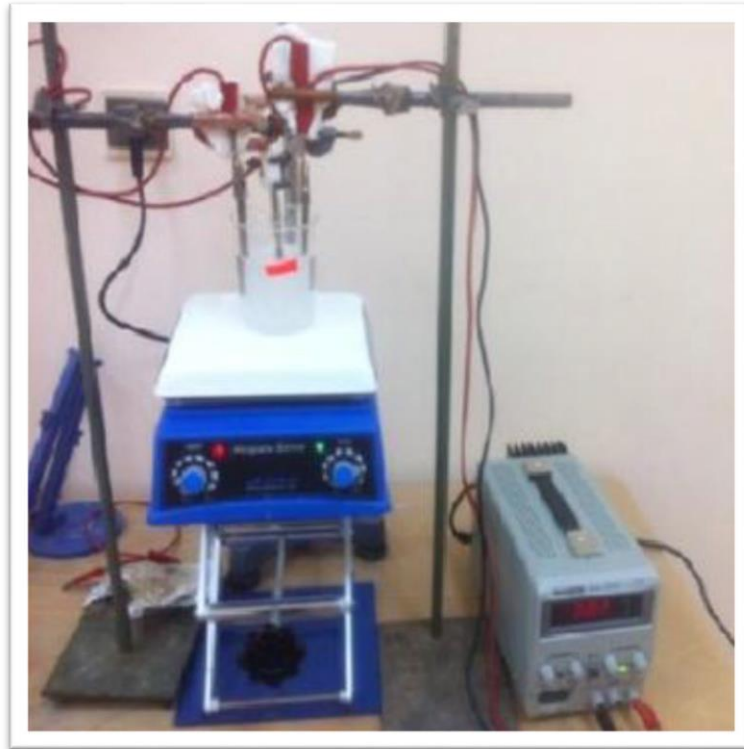
Figure III.2 : Schéma de montage de dégraissage électrolytique.
