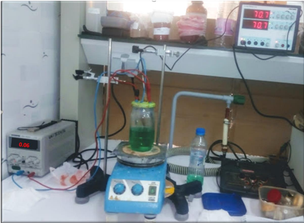
Figure III.4 : Dispositif expérimental de l'électrodéposition Ni-P.
