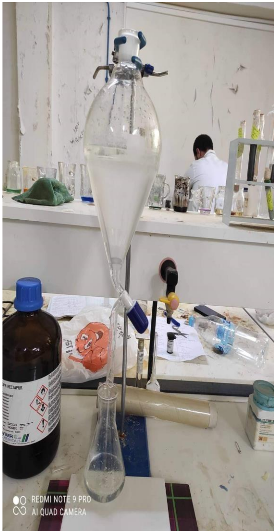
Figure N° 25 : montage de séparation liquide-liquide (décantation)
