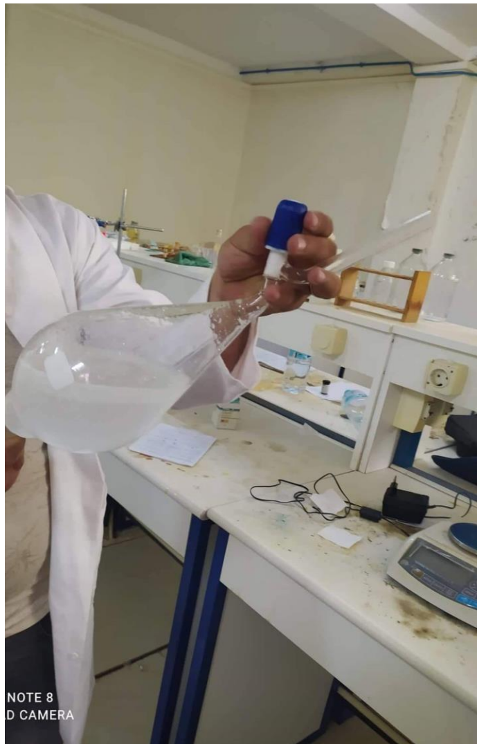
Figure N° 25 : montage de séparation liquide-liquide (décantation)
