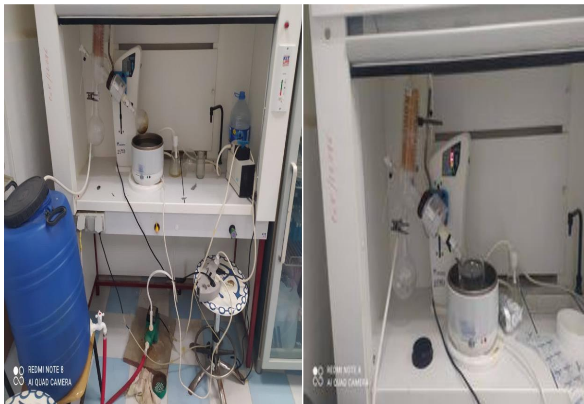
Figure N° 26 : montage de l'évaporateur rotatif
