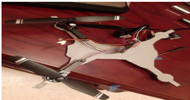
Figure V.2: Installation des moteurs sur le châssis
