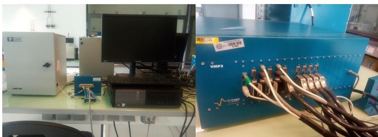
Figure 13 : Le système de mesure électrochimique (Boîte de Faraday et le potentiostat VMP3)
