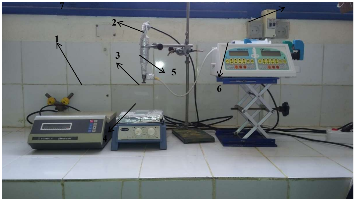
Figure II. 7. Dispositif de dépôt de couches minces par spray pyrolyse ultrasonique.
