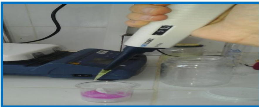
Figure 13. L'ajoute de quelque gouttes de phénolphtaléine
