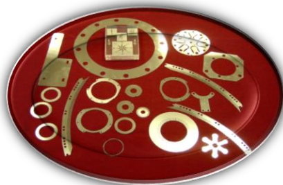
Fig. I.60 Pièces réalisées par usinage photochimique.
