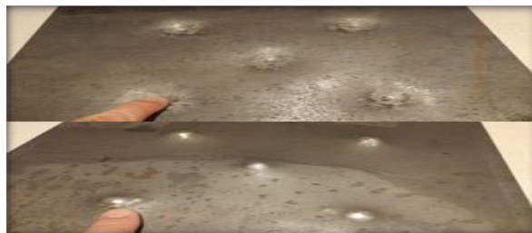
Fig. II.36.Usure thermique (déformation plastique)
