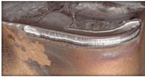
Fig. II.34.Usure en entaille (adhérence).
