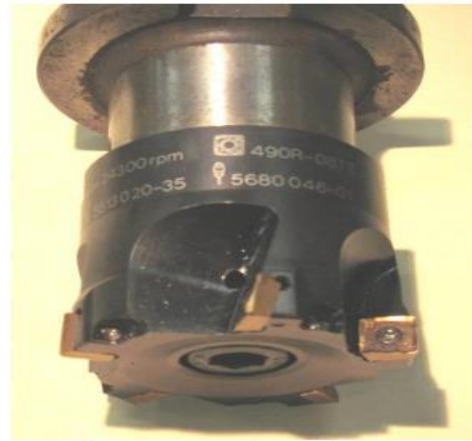
Fig. II.12. Fraise avec plaquettes en carbure métalliques
