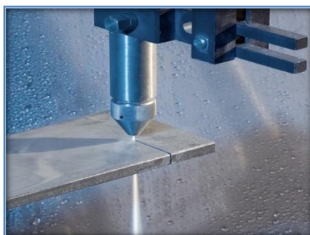
Fig. I.58. Découpage par jet d'eau.
