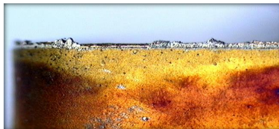
Fig. II.33. Usure en cratère (chimique).
